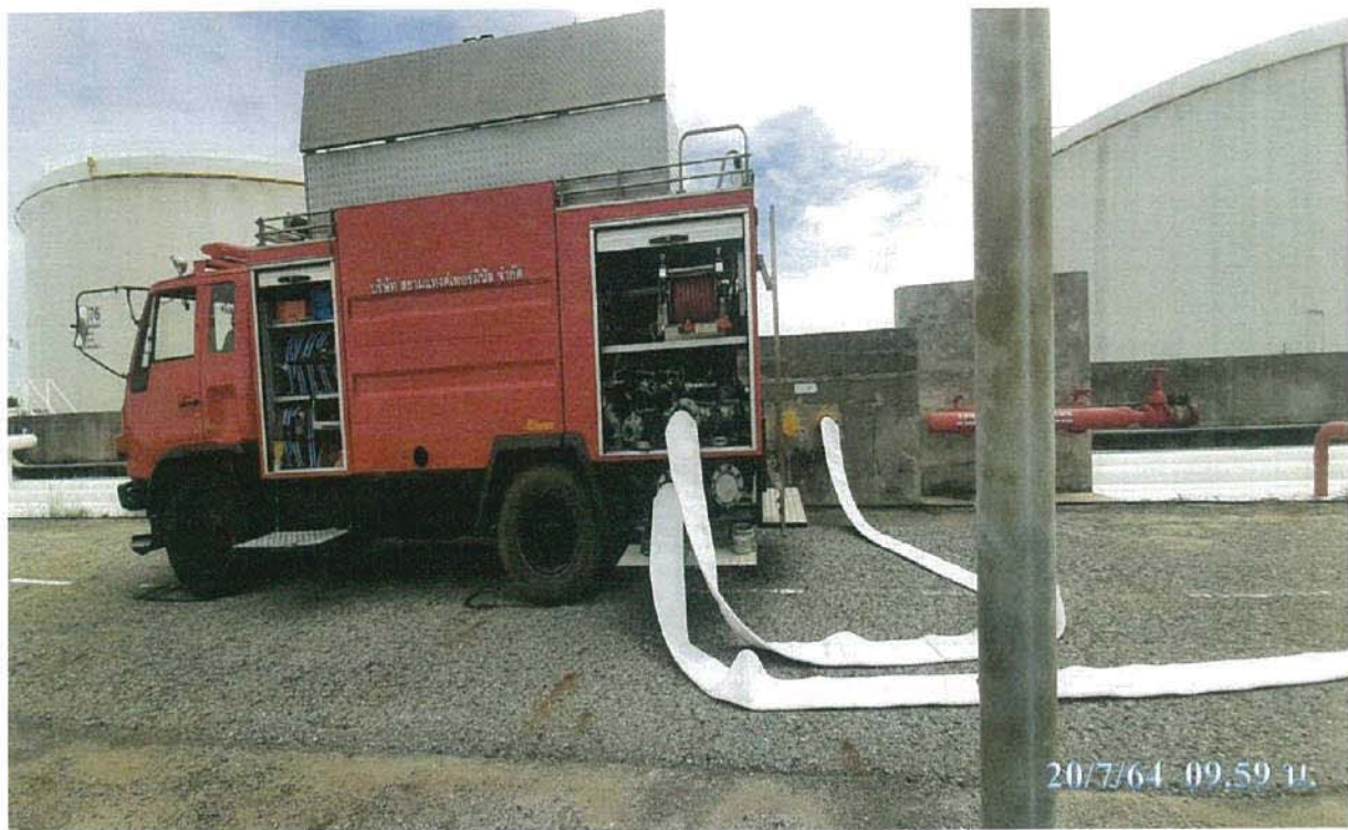
STT 12 รถดับเพลิงจ่าย FOAM ไปยัง FOAM CHAMBER ถึง T - 975
