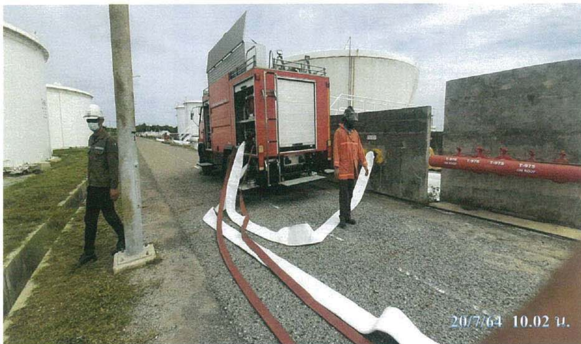
STT 14 รถดับเพลิง 6 ล้อ รับ FOAM จากรถบรรทุก Foam 10 ล้อ ส่ง Foam ไปถัง T - 975
