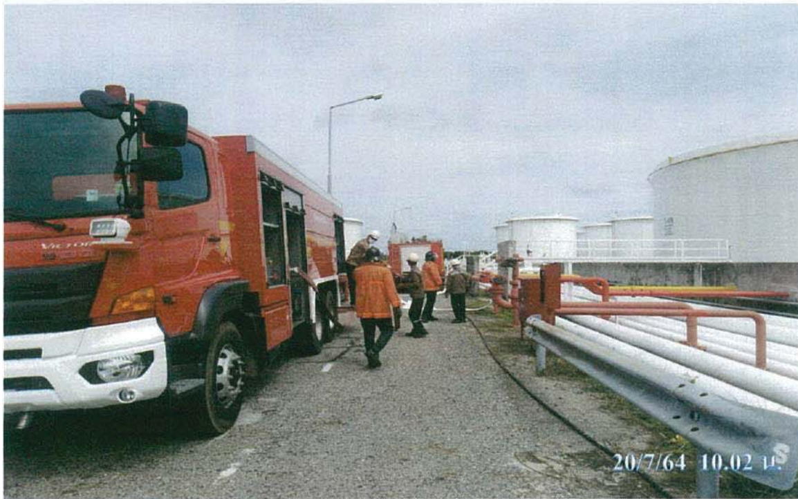
STT 15 รถดับเพลิง 6 ล้อ รับ FOAM จากรถบรรทุก Foam 10 ล้อ ส่ง Foam ไปถัง T - 975
